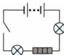
1) Две электролампы и звонок
